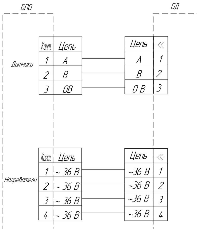
Рисунок 2.1 - Схема электрическая соединений БПО с БД
